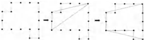
图 5 轮廓点简化过程示意图 Fig. 5 Schematic diagram of outline point simplification process
