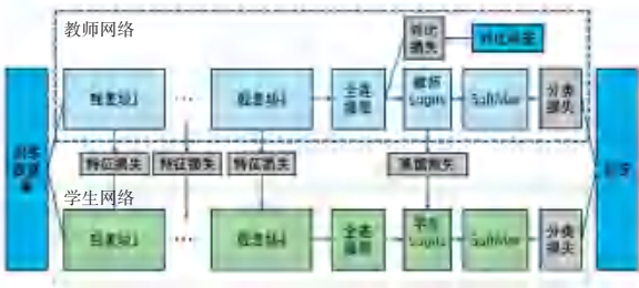
图 3 在线知识蒸馏网络结构图
