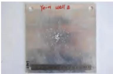
图8 碎片云撞击后板形成的弹坑图像
